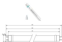
Scheda tecnica Philips Tubo LED T8 MASTER Value (EM/Mains) Ultra Output 23W 3700lm - 865 Luce del Giorno | 150cm - Sostitutiva 58W
